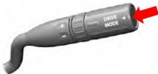
Die Tow/Haul-Funktion optimiert die Schalteistung und verringert die Gefahr einer Überhitzung oder eines Ausfalls des Getriebes durch übermäßiges Schalten beim Fahren in bergigen Gegenden. Diese Funktion bietet zusätzliche Leistung beim Bergauffahren und Bremsunterstützung durch den Motor beim Bergabfahren, um das Risiko einer Überhitzung der Fahrzeugbremsen zu verringern. Wählen Sie diese Funktion durch Drücken der Taste im Schalthebel auf der rechten Seite des Lenkrads.
