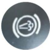
Die Dieselmotorbremse kann zusammen mit der Abschleppfunktion verwendet werden. Wenn sie aktiviert ist, wird die Bremsunterstützung durch den Motor verstärkt, was ein besseres Fahrverhalten und eine bessere Kontrolle sowie einen geringeren Verschleiß von Bremsen und Getriebe beim Bergabfahren ermöglicht. Drücken Sie die Taste auf dem Armaturenbrett (rechts neben dem Lenkrad, unterhalb des Allradantriebs), um die Funktion ein- oder auszuschalten.
