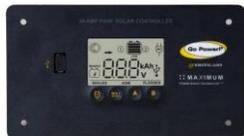
Das Wohnmobil ist mit einer Solaranlage auf dem Dach ausgestattet, die die Hausbatterien auflädt, wenn sie dem Sonnenlicht ausgesetzt ist. Das Solarsystem ist automatisiert und muss nicht manuell bedient werden. Bitte nehmen Sie keine Änderungen an den Standardeinstellungen auf dem Bedienfeld vor.
